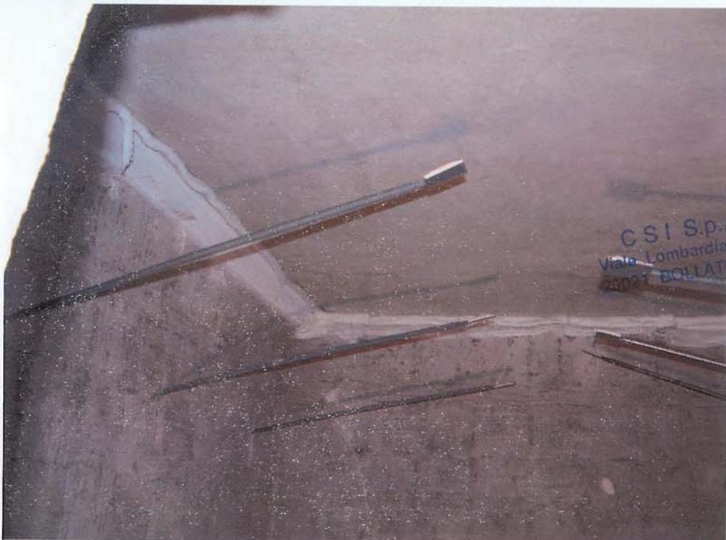
Foto 2. Lato esposto al fuoco del solaio prima della prova - vista dall'interno della camera d'incendio
