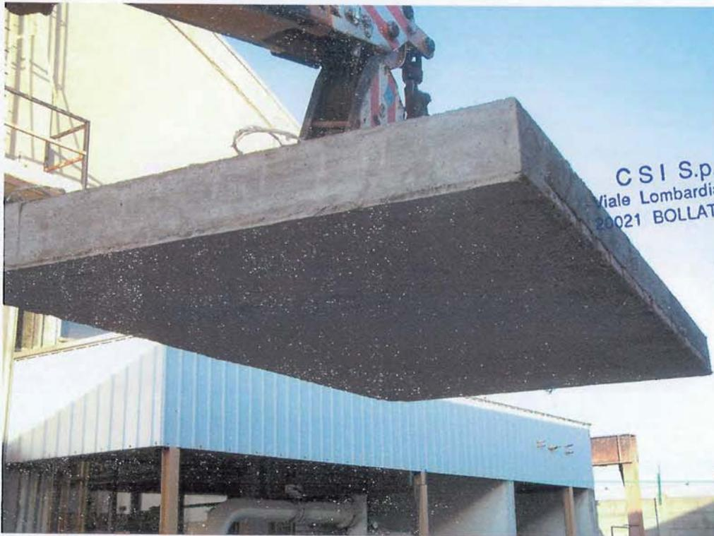
Foto 1. Lato esposto al fuoco del solaio prima della prova
